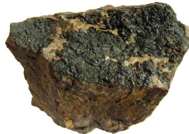
Mineral Metálico-Pechblenda  $\text{U}_3\text{O}_8$ ;
